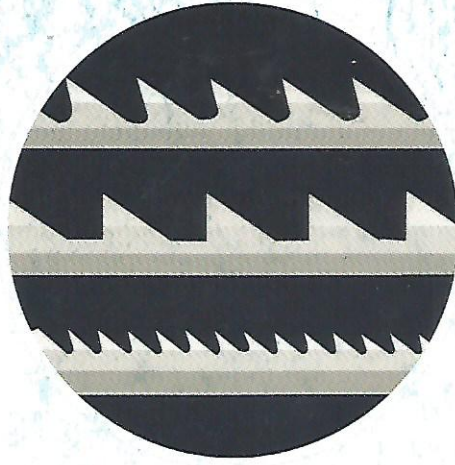
Obicia elastyczne i druty piłowe Flexible, metallic card clothing
